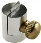
EM-Tec PV5 ミニサンプルバイスクランプは、0~5mm の厚さのサンプルを固定できます。サンプルはバイスのジョーの間に垂直に保持されます。バイスのジョーは真鍮のつまみネジで締め付けられます。このサンプルホルダーは完全に非磁性です（アルミニウムと真鍮）。ピンを除いたホルダーサイズは Ø12.2x17mm です。
