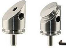
EM-Tec P38 は、TFS / FEI ピンスタブ用の 38° 固定傾斜ホルダーです。TFS / FEI デュアルビーム FIB システムにおいて、サンプルを 38° 傾斜させるのに使用します。ピンを含まないサイズは Ø12.7 x 17 mm です。
