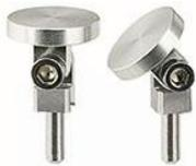
EM-Tec PS15 は、ピンスタブ スイベルマウントです。マウントのヘッドは、各方向に 90 度傾けることができる回転ヒンジを介してピンに接続されています。傾斜機能のない SEM やランダムな傾斜角度が必要な場合に最適なマウントです。希望の傾斜角度を設定したら、ソケットキャップスクリューでトップを固定します。
