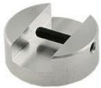
EM-Tec JS12 シリンダースタブバイスクランプは、0~12mm の厚さのサンプルを固定します。サンプルはセットスクリューで垂直に保持します（複数の長さをご用意しています）。Ø25x10mm のスタブサイズに基づいた、コスト効率が高く実用的な小型バイスクランプ。
