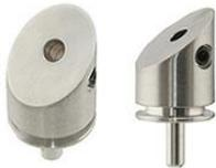
EM-Tec P36 36° 角度固定傾斜ホルダー（Zeiss ピンスタブ用）。Zeiss CrossBeam FIB システム用にサンプルを 36° 事前傾斜させるのに使用します。ピンを含まないサイズは Ø12.7 x 17 mm です。
