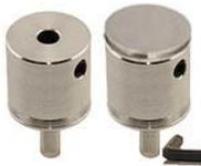
EM-Tec PH10 ピン スタブ エクステンダー、高さ 10mm 追加、 $\text{\O}12.7 \times 22.7\text{mm}$ 、アルミ製。ステージの Z 軸を使用せずに、サンプルを SEM のポールピースに近づけるために必要な高さを追加したい場合に使用します。六角レンチが付属しています。
