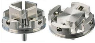
サンプルは4つの小さな止めネジで垂直に保持されます。断面や薄いサンプルを観察するのに最も効果的な方法です。ピンを除いたホルダーサイズは  $\text{Ø}25.4 \times 7.2\text{mm}$  です。
