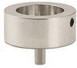
EM-Tec PS16 ピン スタブは、最大 Ø16.0mm までの円形サンプルをクランプします。サンプルはセットスクリューで固定されます。ピンスタブの先端直径は 25mm です。
